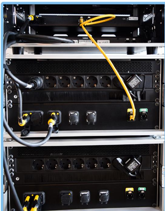
Auf der Rückseite ist der Stromanschluss als powerCON True1 Gerätestecker ausgeführt. Ebenso können externe Geräte wie Nodes und Splitter an die powerCON und True1 Durchschliff-Buchsen, PC oder Handy an die Schuko-Steckerleiste angesteckt werden.
